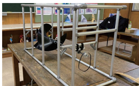
完成した小水力発電の初号機外枠
